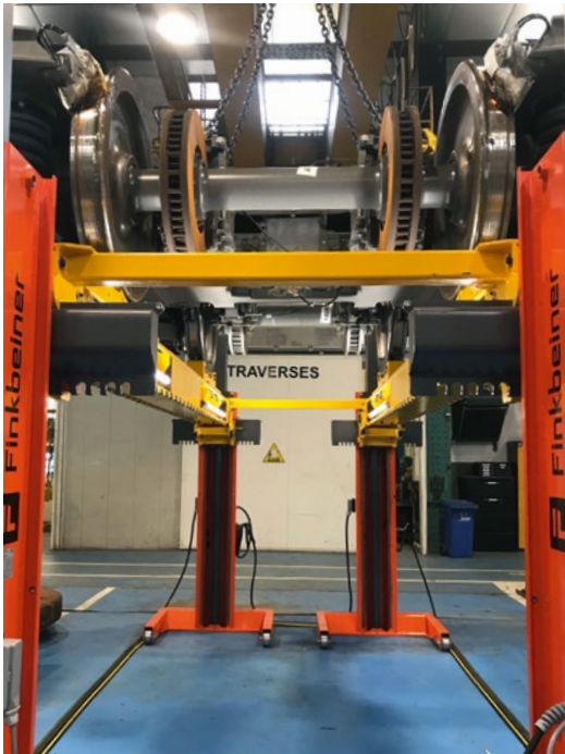
Ligne HKL5 - 5 passerelles suiveuses, 1 transique avec pont roulant, 2 préhenseurs à ventouse ALSTOM CRESPIN
